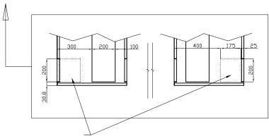
Passaggio per allacciamenti/ Durchgang für Verbindungen/ Passage pour les connexions Passage for connections/ Paso para las conexiones
